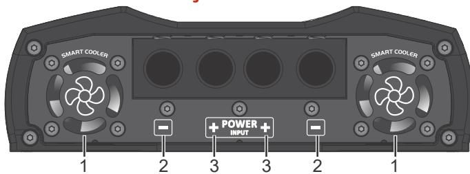
**1 - SMART COOLER:** Este amplificador possui dois coolers de ventilação interna. Para perfeito funcionamento, o amplificador deve ser instalado em local seco e arejado, com espaço livre de no mínimo 1" (25mm) de cada lado. A temperatura normal de trabalho deste amplificador é de 65°C.
